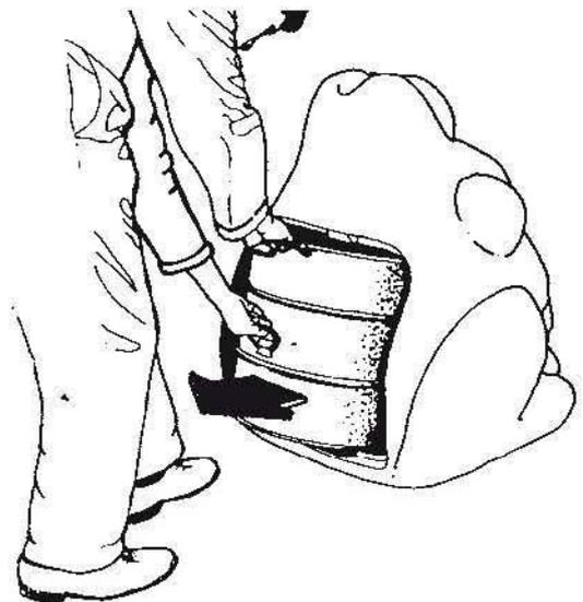
**2** Levantar y arrastrar hacia afuera el cubo de acero galvanizado con la ayuda de las dos asas.
